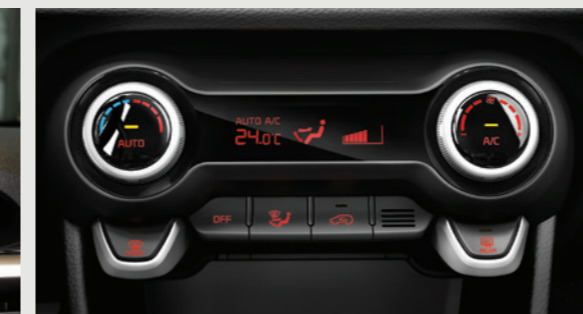
HỆ THỐNG ĐIỀU HOÀ TỰ ĐỘNG Tự điều chỉnh nhiệt độ và tốc độ quạt gió mang đến sự thoải mái trên mọi hành trình
